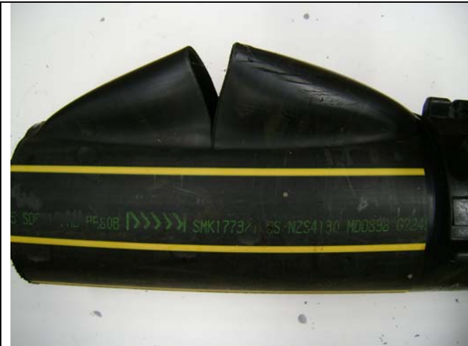
Fig. 1 Burst PE 80B pipe
