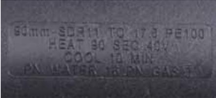
**3) Moulded-in welding parameters**
